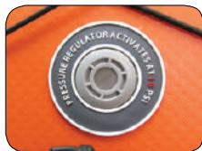
Βαλβίδα αυτόματης αποσυμπίεσης σε περίπτωση υπέρ-φουσκώματος
